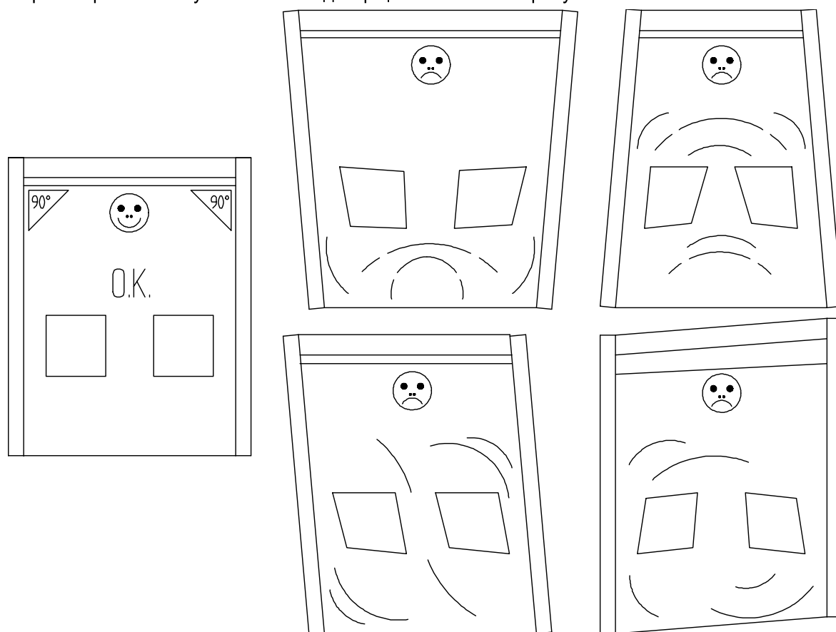
Рисунок 6-8. Установка ворот под правильными углами
