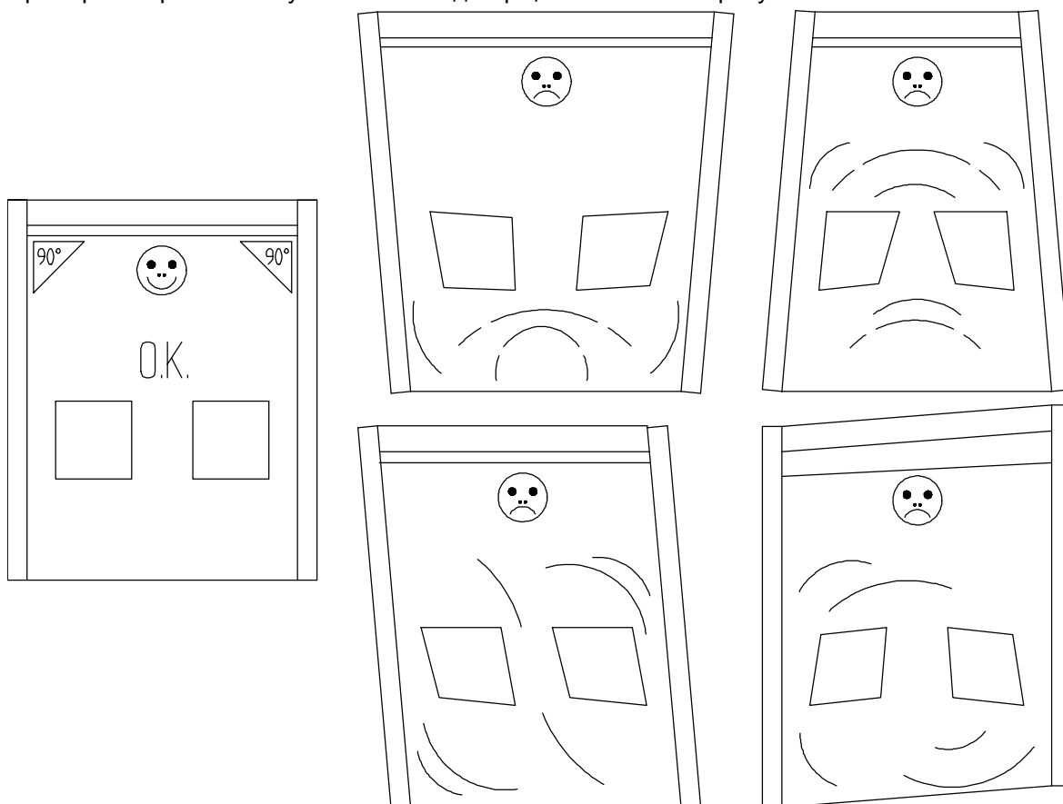
Рисунок 6-7. Установка ворот под правильными углами
