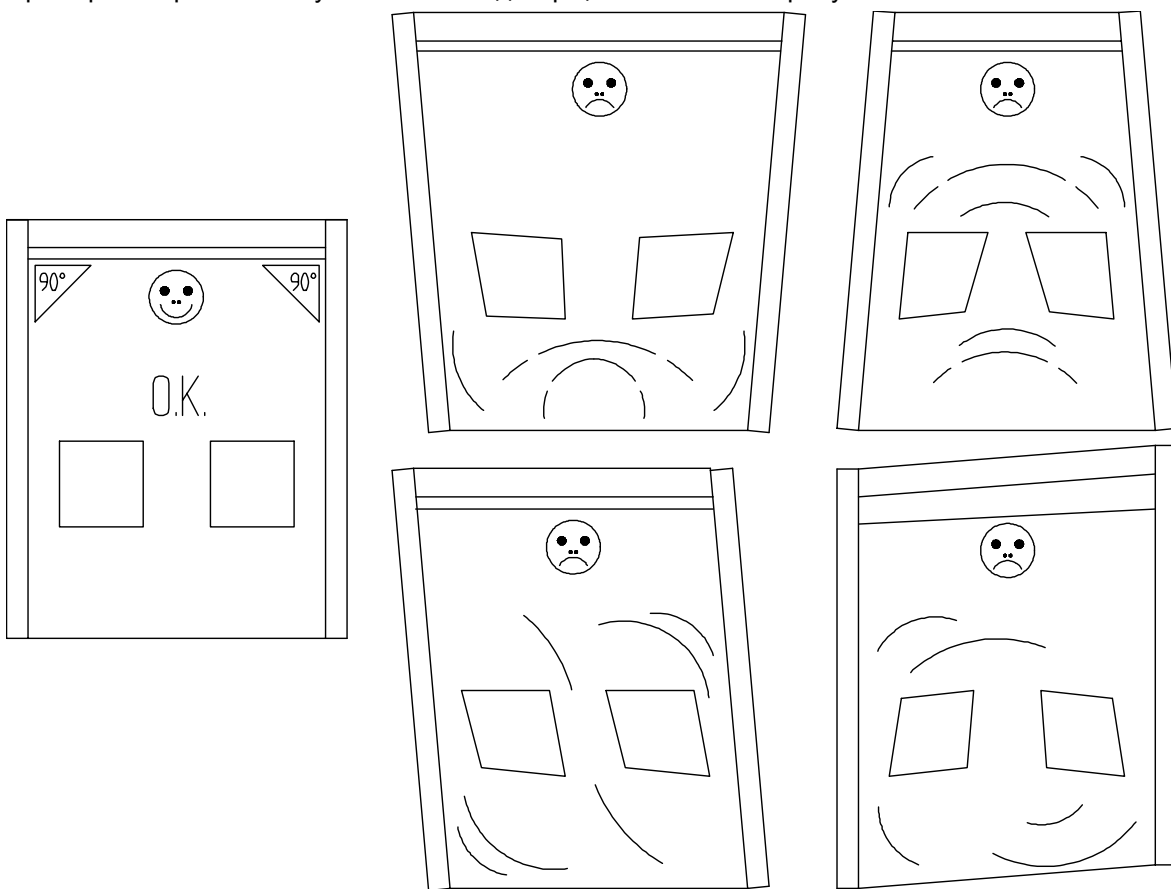
Рисунок 5-7. Установка ворот под правильными углами
